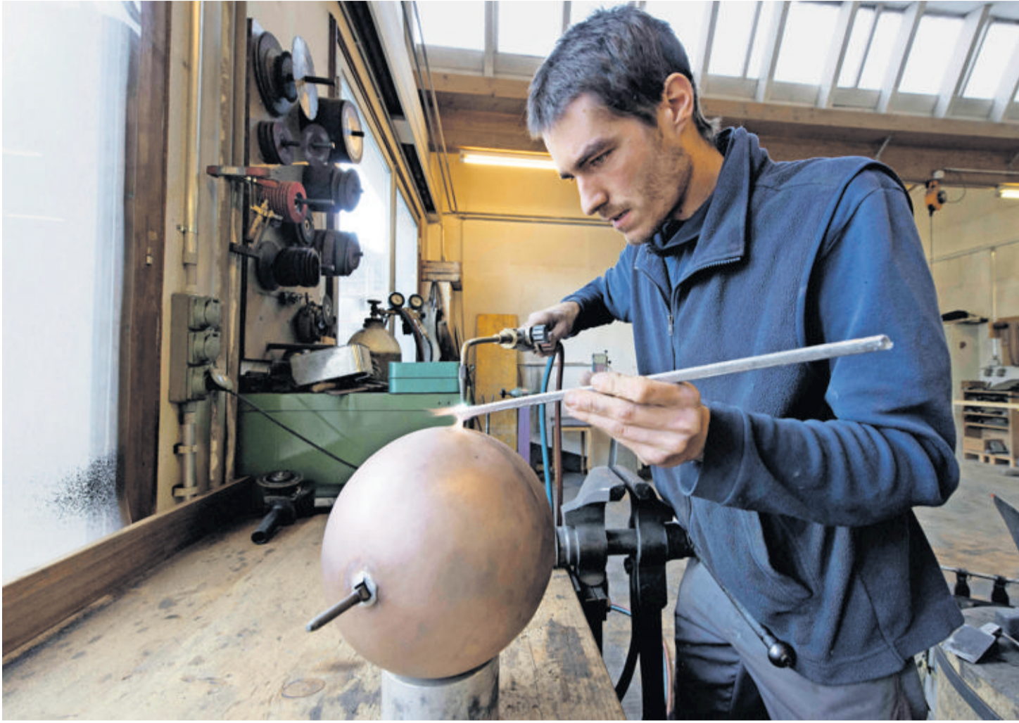
Chez Mecatal, Olivier Chammartin soude la lune minutieusement à l'étain, pour garantir une étanchéité parfaite. JEAN-PAUL GUINNARD
